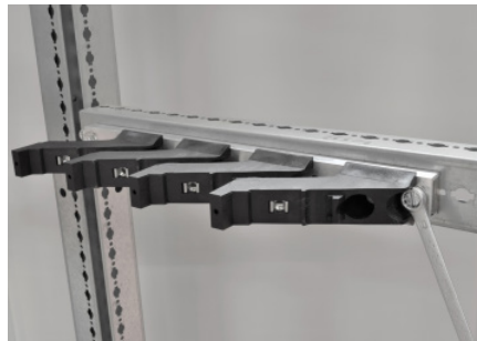
Fije el soporte utilizando los tornillos M6 (par de apriete 10 Nm)
