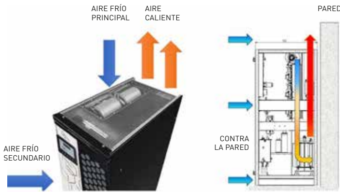
Figura 23: La ventilación superior y frontal permite la instalación contra la pared con ahorro de espacio en el suelo.
